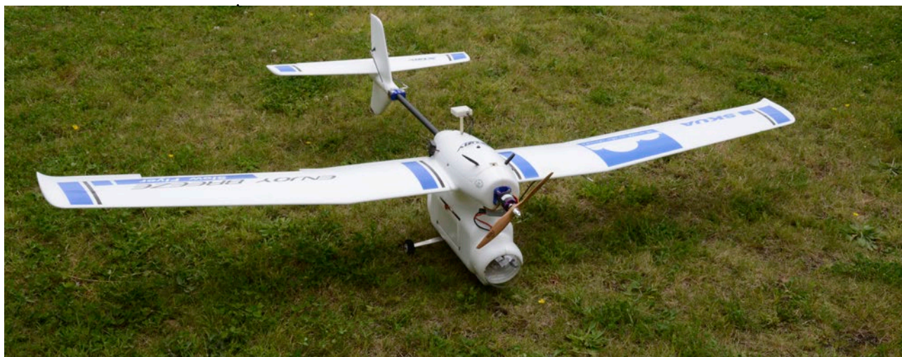
Figura 11: Drone de asa fixa de construção customizada. Fuselagem X-UAV Skua com piloto automático 3DR Pixhawk, GNSS uBlox M8N, Motor Profissional Sem Escovas Purple Power PO-3548-1100, hélice de madeira 10X6, T-motor ESC 60A, servos de metal digital FrSky e bateria de 10000MAH. © Laboratório de Drones da Universidade de Exeter
