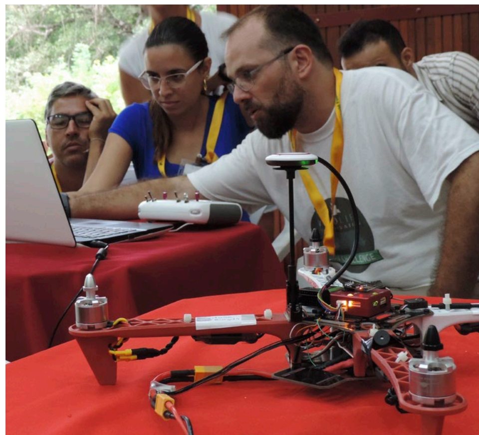
Figura 20: Montando drones multirotores de baixo custo com o piloto automático Pixhawk no Cerrado brasileiro. © WWF-Brasil
