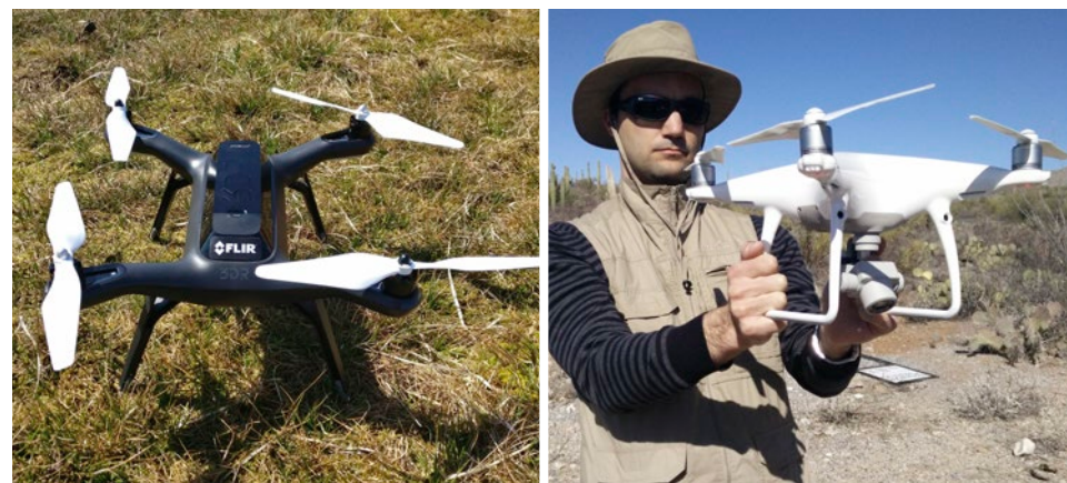
Figura 18: Drones comerciais: à esquerda, o 3DR Solo, e à direita, o DJI Phantom 4. Ambos incluem câmeras em estabilizadores, peso de decolagem <2kg e podem voar por 15–25 minutos com uma única bateria (<US$ 1.500). © Laboratório de Drones da Universidade de Exeter
