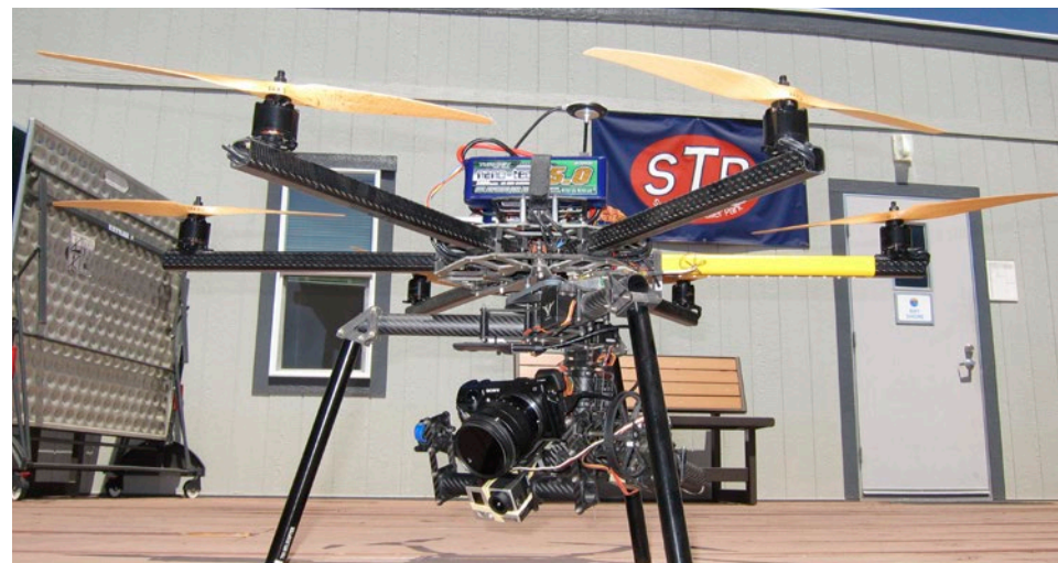
Figura 22: Este drone customizado conta com 6 rotores para transportar uma câmera SLR para fotografias profissionais. © Chris Hunkeler/Creative Commons
