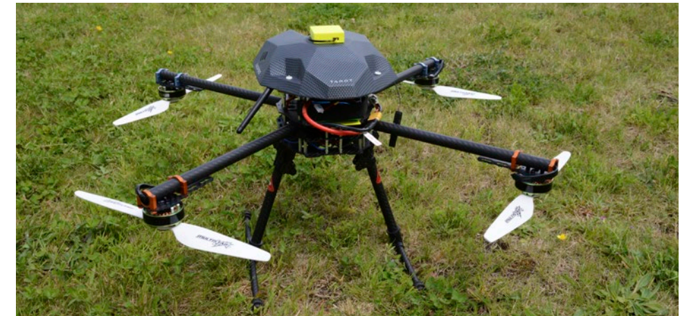
Figura 19: Quadricóptero Tarot 650 modificado com piloto automático 3DR Pixhawk, motor e hélices Multistar, GNSS u-blox M8N e bateria de 1.000 MAH. © Laboratório de Drones da Universidade de Exeter
